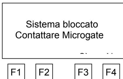
Si verifica se è stata rilevata un'anomalia durante i test iniziali sulla macchina. Contattare Microgate per ulteriori informazioni.
